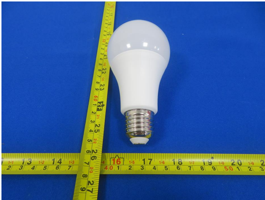
Fig. 2 (Lamp cap type: E27)
