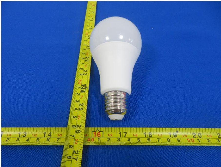
Fig. 2 (Lamp cap type: E27)
