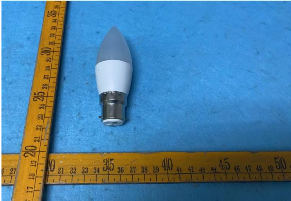
Fig. 3(Lamp cap type: B22(d))
