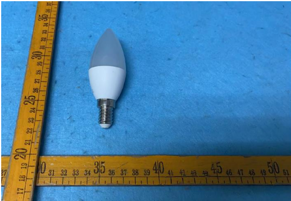
Fig. 4(Lamp cap type: E14)
