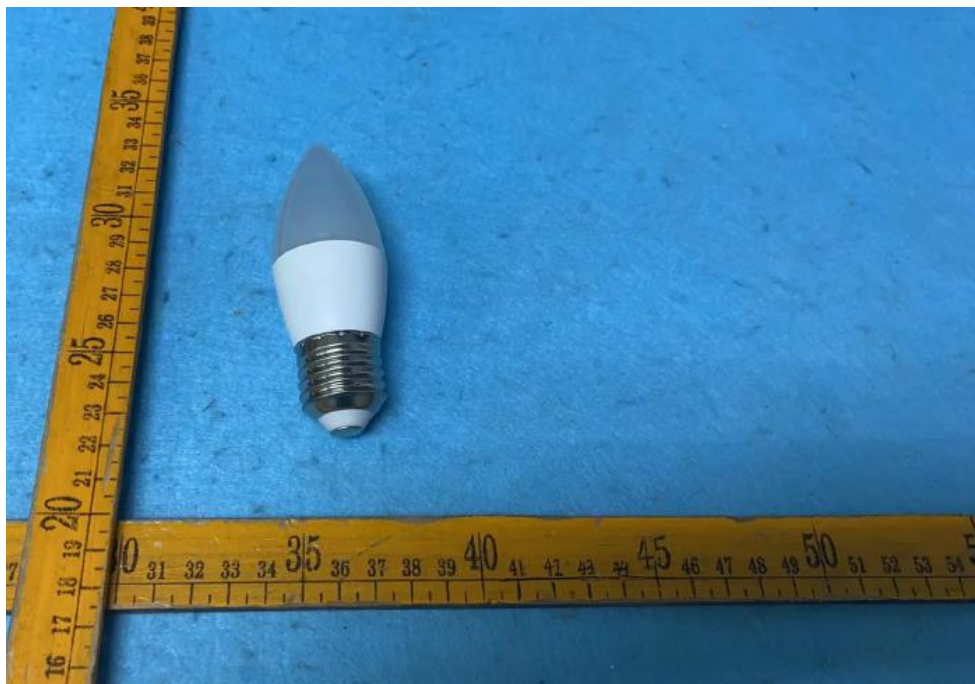
Fig. 2 (Lamp cap type: E27)
