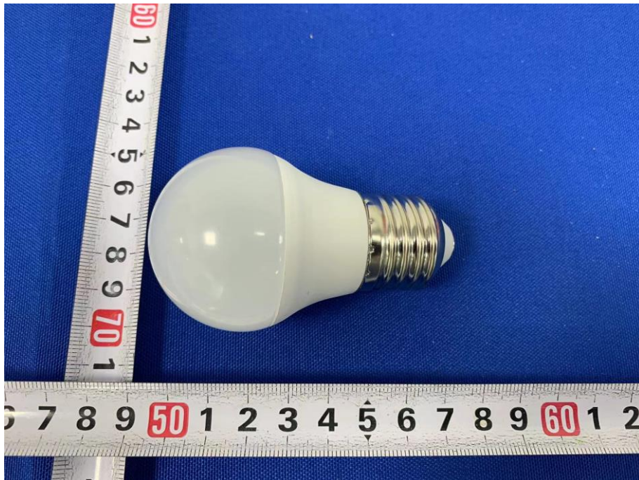
Fig. 1 (Lamp cap type: E27)
