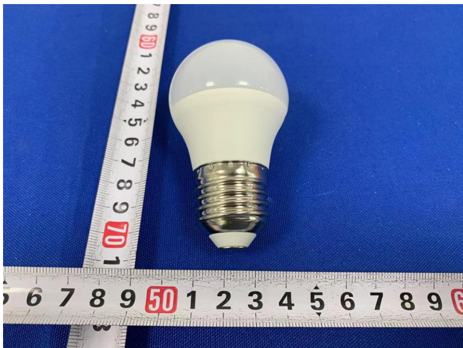
Fig. 2 (Lamp cap type: E27)
