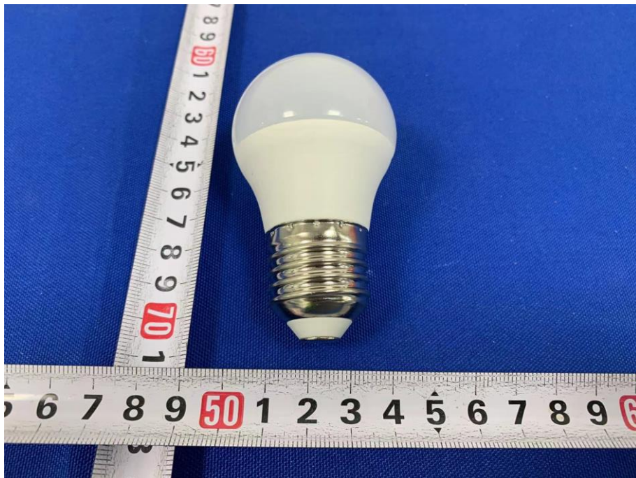
Fig. 2 (Lamp cap type: E27)
