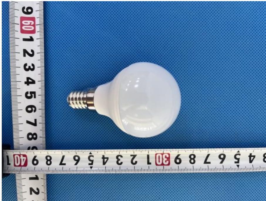
Fig. 5 (Lamp cap type: E14)
