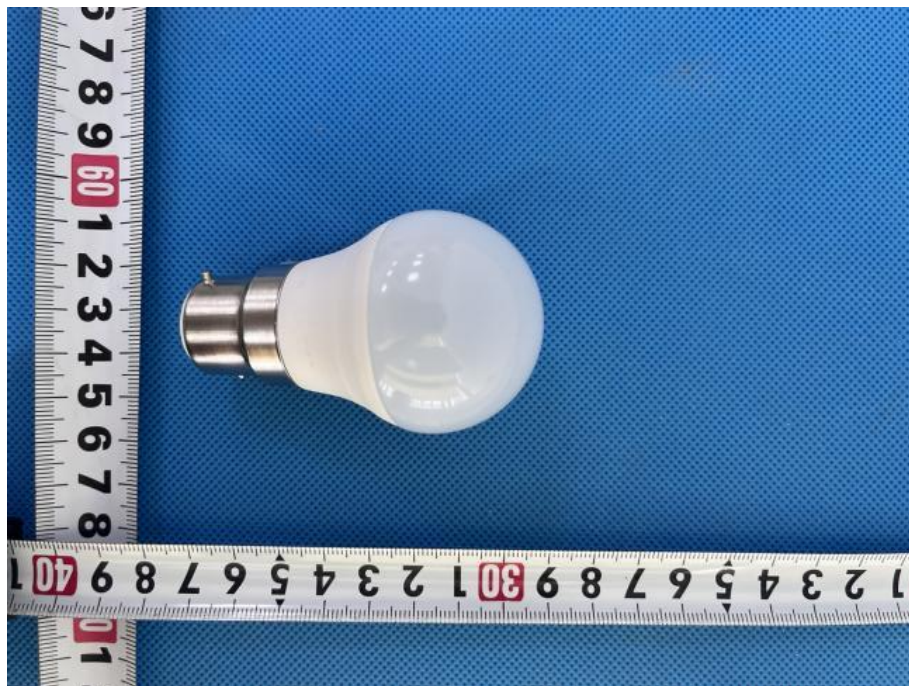
Fig. 4 (Lamp cap type: B22d)
