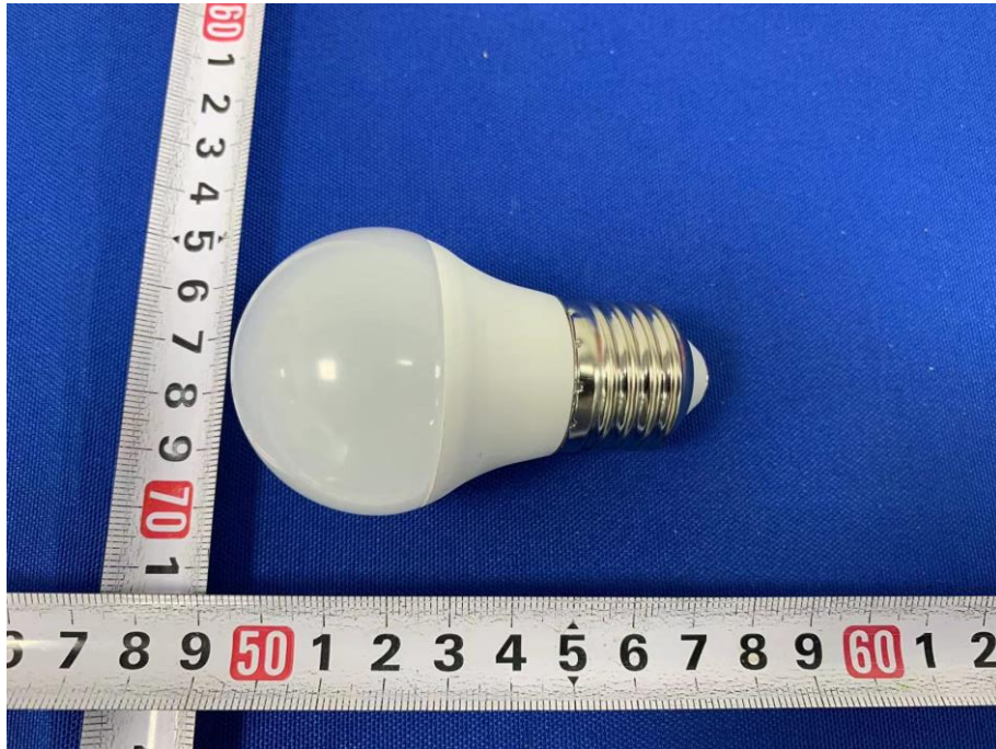
Fig. 1 (Lamp cap type: E27)
